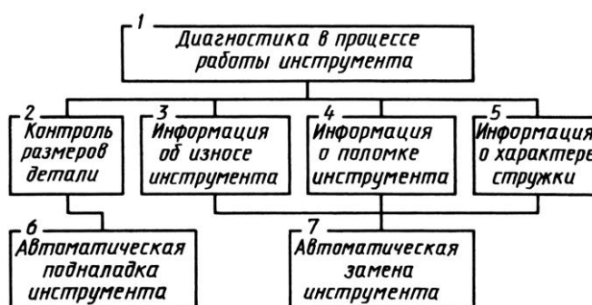
Слайд 34. Подсистема диагностики состояния инструмента в процессе резания
