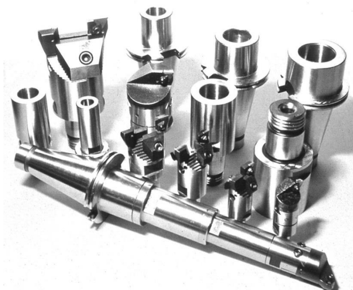
Слайд 17. Система расточного инструмента
