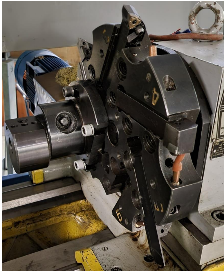
Рисунок 8 – Револьверная головка токарного станка с ЧПУ
