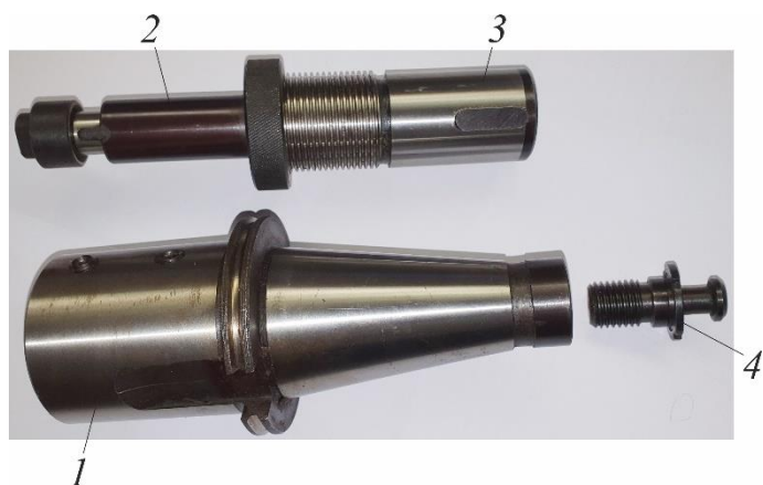
Рис. 6. Элементы УНП для фрезерования дисковыми фрезами: 1 — базисный агрегат; 2 — оправка для дисковых фрез; 3 — унифицированный хвостовик сменной наладки; 4 — затяжной болт
