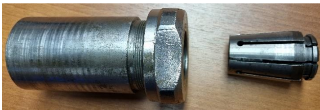
Рис. 10. Модель цангового патрона с комплектом цанг
