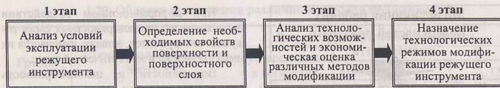
Рис. 1.6. Основные этапы выбора эффективной технологии модификации рабочих поверхностей режущих инструментов
