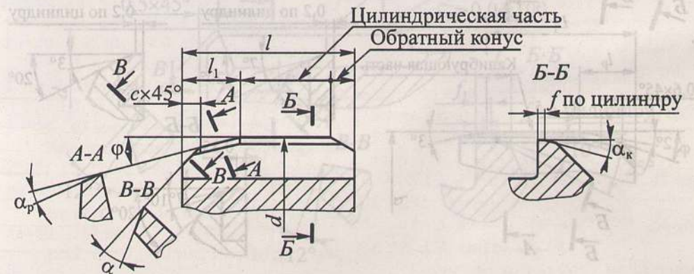
Рис. 4.11. Развертка с отдельными заходным и режущим участками
