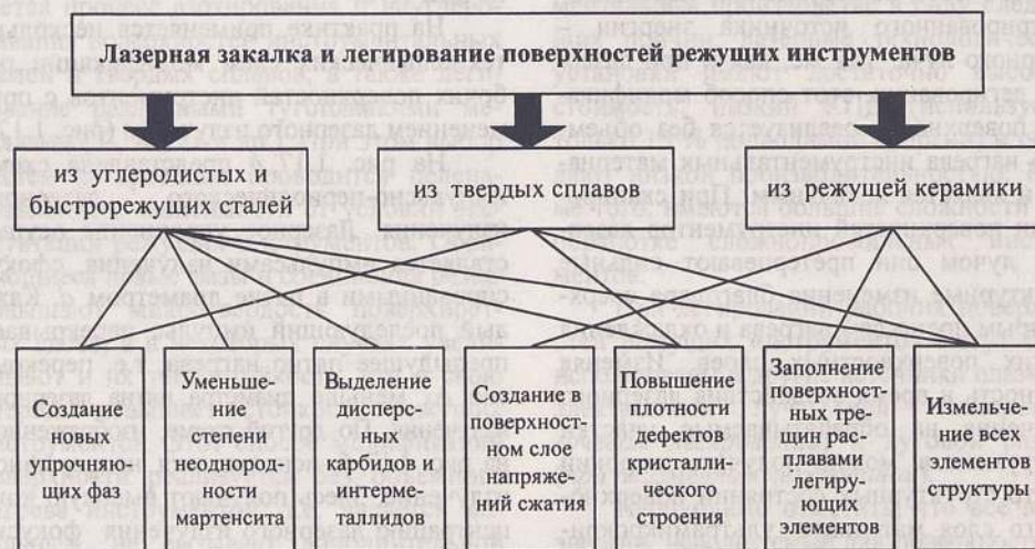
Рис. 1.18. Механизм повышения износостойкости режущих инструментов при лазерном воздействии (закалке и/или легировании)
