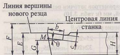
Рис. 3.5. Расположение режущей пластины в державке резца
