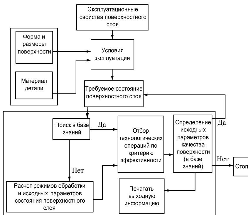
Рис. 2.6. Алгоритм получения требуемого состояния поверхностного слоя детали
