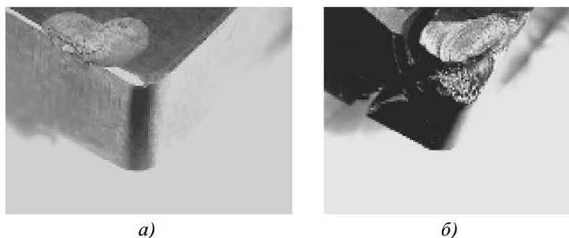
Рис. 4.10. Случаи скалывания режущих пластин из нитридной керамики на основе \text{Si}_3\text{N}_4 при фрезеровании чугуна: a — скол передней поверхности; б — скол вершины
