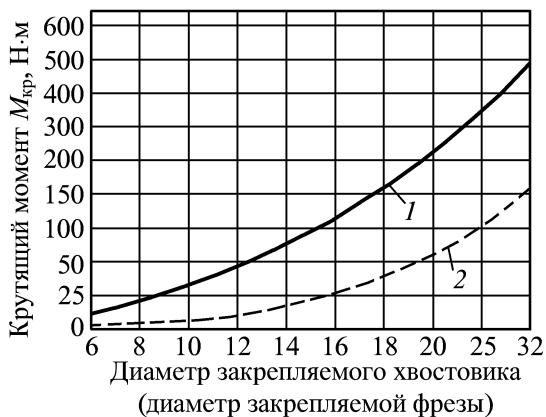
Рис. 18. Зависимости крутящего момента M_{кр} : 1 — от диаметра закрепляемого хвостовика; 2 — справочно — момент сил резания при фрезеровании
