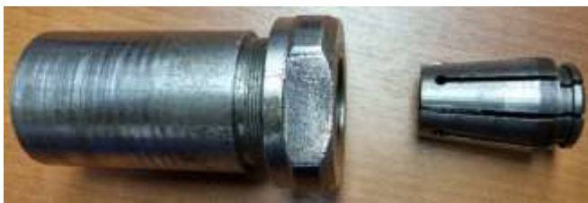
Рис. 10. Модель цангового патрона с комплектом цанг
