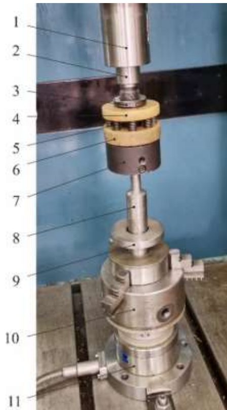
Рис. 10. Измерение крутящего момента:
