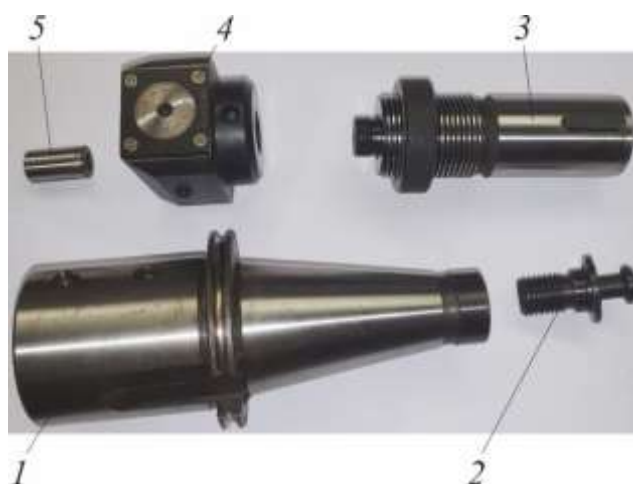
Рис. 8. УНП для выполнения переходов растачивания отверстий: 1 — базисный агрегат; 2 — зажимной болт; 3 — сменная наладка — оправка расточного патрона; 4 — расточной патрон; 5 — сменная втулка-переходник
