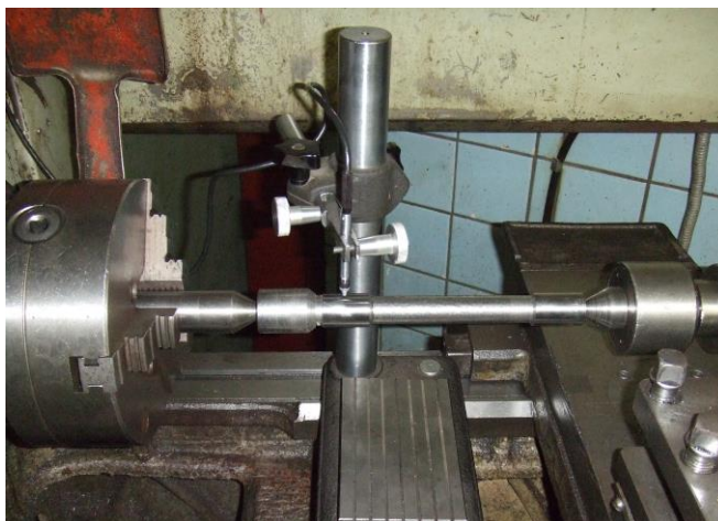
Рис. 14. Измерение детали, закрепленной в центрах, один из которых закреплен в патроне
