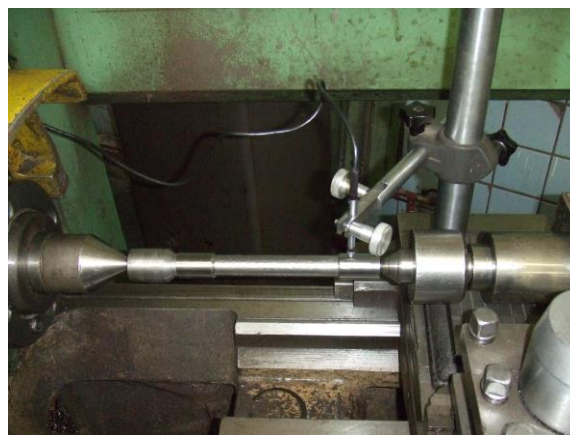
Рис. 15. Измерение конусности детали, закрепленной в центрах
