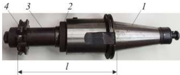
Рис. 7. УНП для выполнения перехода фрезерования дисковой фрезой: 1 — базисный агрегат; 2 — регулировочная гайка; 3 — сменная наладка — оправка для дисковых фрез; 4 — дисковая фреза
