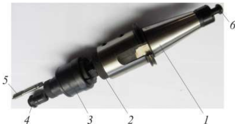
Рис. 11. УНП для нарезания резьбы метчиками:
