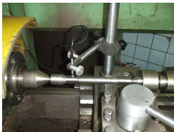
Рис. 15. Измерение конусности детали, закрепленной в центрах
